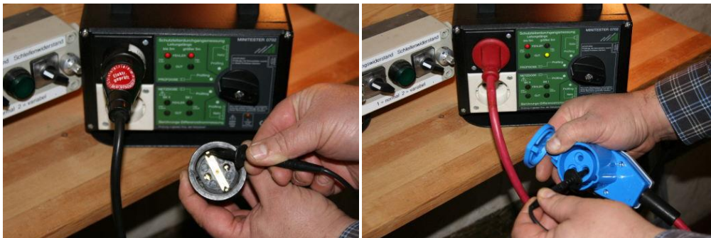
links defekte Leitung rechts Leitung ok, aber über 5 m
